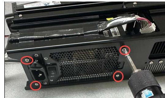
6.3 拆除左侧固定工字型铁块的 2 颗螺丝
