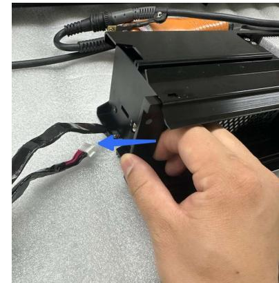
\*6.5 分离电源与 HASH 板：沿电源出口方向稍微用力，由于电源接口高于黑色框体，所以此步骤只为起松动的作用，便于下一步操作\*
