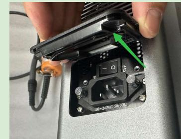
4.4 使用卡簧铁杆拆卸固定电源接口的 2 颗螺柱
