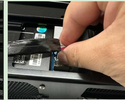
6.2 拆除底部固定电源的 4 颗螺丝
