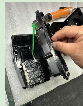
3.6 拆除固定 MM 板的 4 颗螺丝
