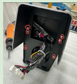
4.6 取下挡板并解开连接线
