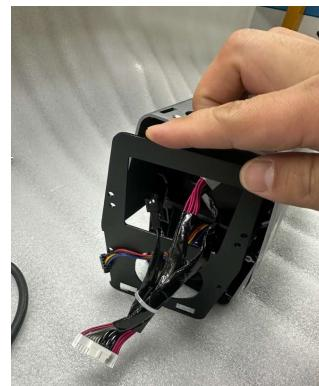
4.7 拆除右侧底部固定磁吸连接件的 2 颗螺丝
